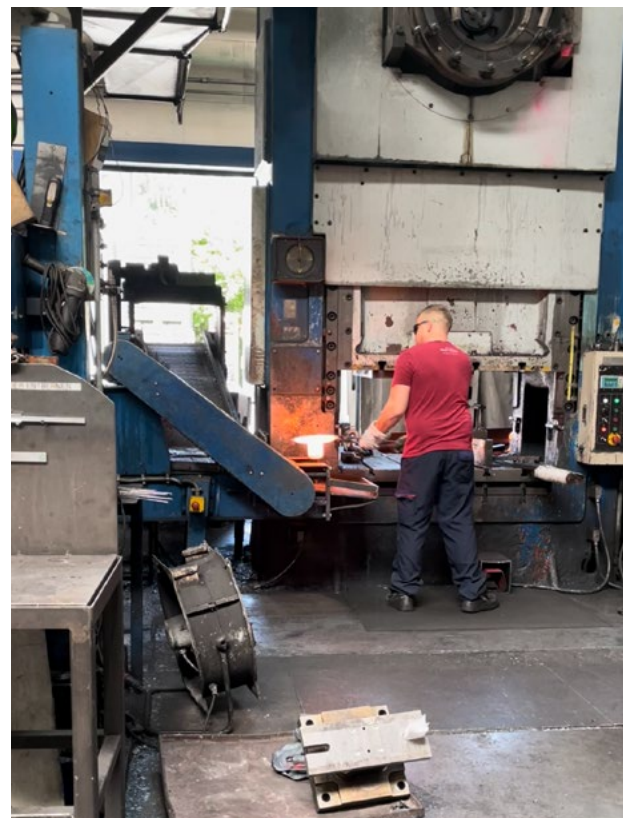
Rühlicke-Produktionsstätte in Österreich: Schmiedeprozess von Zugsattelzapfen Rühlicke production facilities in Austria: Forging of a king pin
